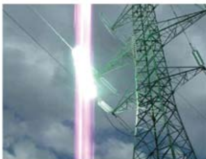
Slika 12 — Luk za vrijeme dvopolnog kratkog spoja (L1-L2) za vrijeme ispitivanja
