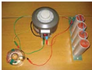
Slika 10 – Eksperimentalni ferorezonantni krug Figure 10 – Experimental ferroresonant circuit
