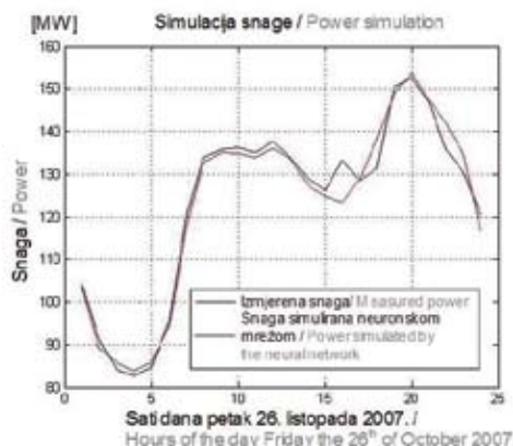
Slika 11 – Prognoza opterećenja po završetku procesa testiranja za dan petak 26. listopada, te usporedba s izmjerenom vrijednošću Figure 11 – Load forecast upon completion of the testing process for the day Friday the 26th of October and a comparison with the measured value
