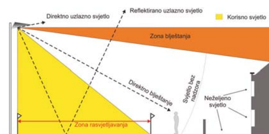
Slika 2 - Primjer korisne rasvjete i štetne, odnosno neželjene, komponente kod tipične cestovne svjetiljke na stupu [Izvor: Institution of Lighting Engineers]
