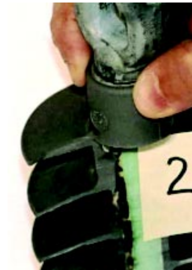
Slika 18. Odljepljivanje na metalnom priključku kao izvor invazije
