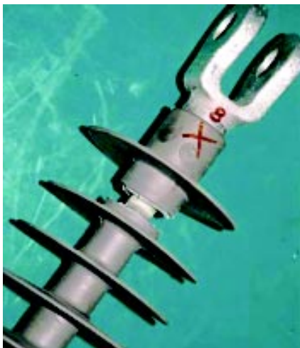
Slika 19. Krhki prijelom fibreglas jezgre kompozita (kod ispitivanja u laboratoriju uz 90% tereta)
