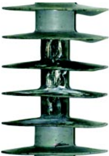
Slika 11. Izloženost fibreglas jezgre utjecaju okoliša
