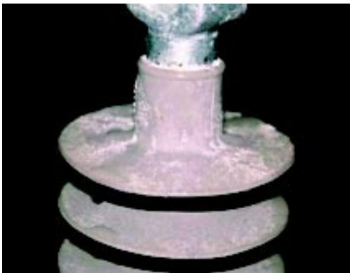
Slika 5. Porast indeksa hidrofobnosti gornjeg rebra (HC 3 do 4 prema STRI klasifikaciji)
