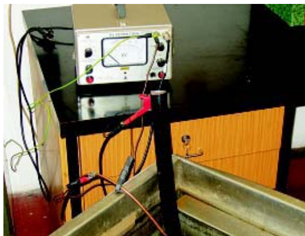
b) Ispitivanjem plašta s 5 kV u vodi nakon oštećenja
