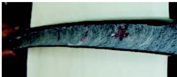
a) Natapanjem plašta u obojenu tekućinu je ispitivano da li je voda došla do bubre trake
