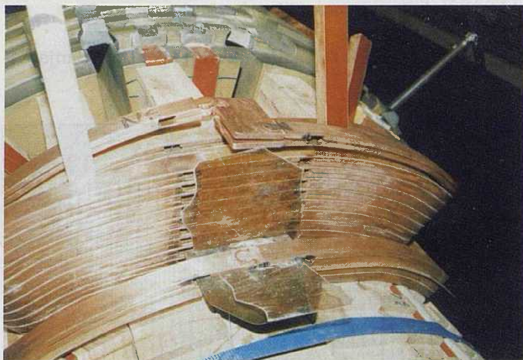
Slika 7. Spojevi polusvitaka u glavi namota
