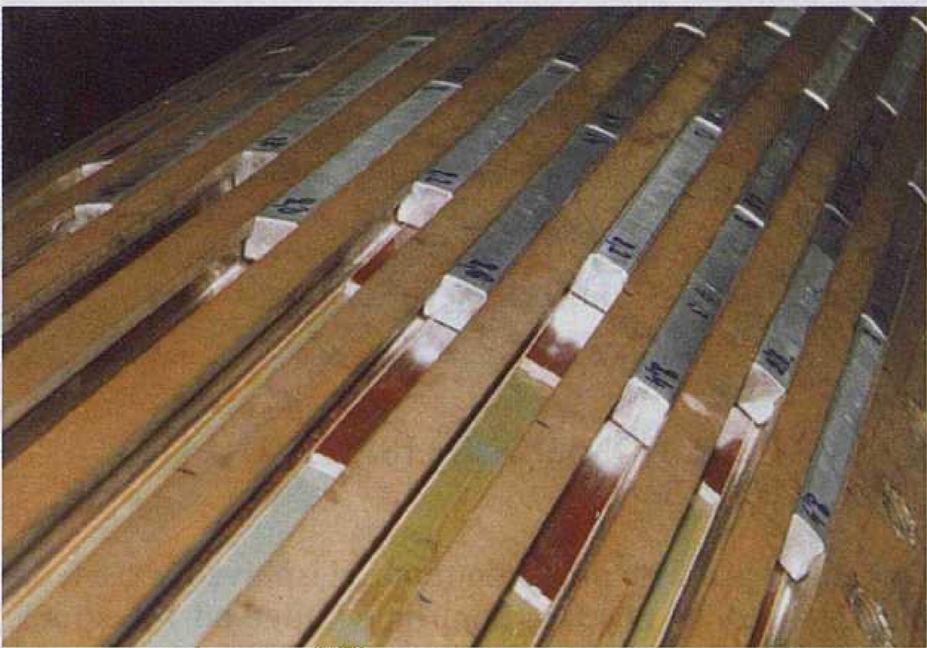
Slika 4. Zaklinjavanje utorskog dijela rotorskog namota s pomaknutim mjestima dodira klinova u susjednim utorima
