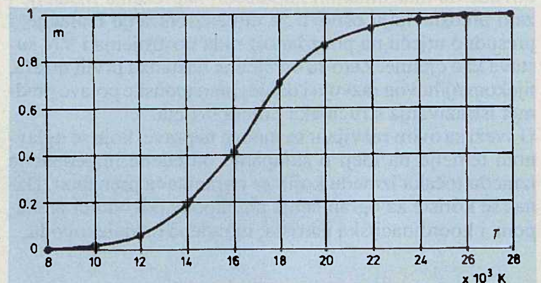
Slika 1. Prikaz stupnja ionizacije u ovisnosti o postignutoj temperaturi luka
