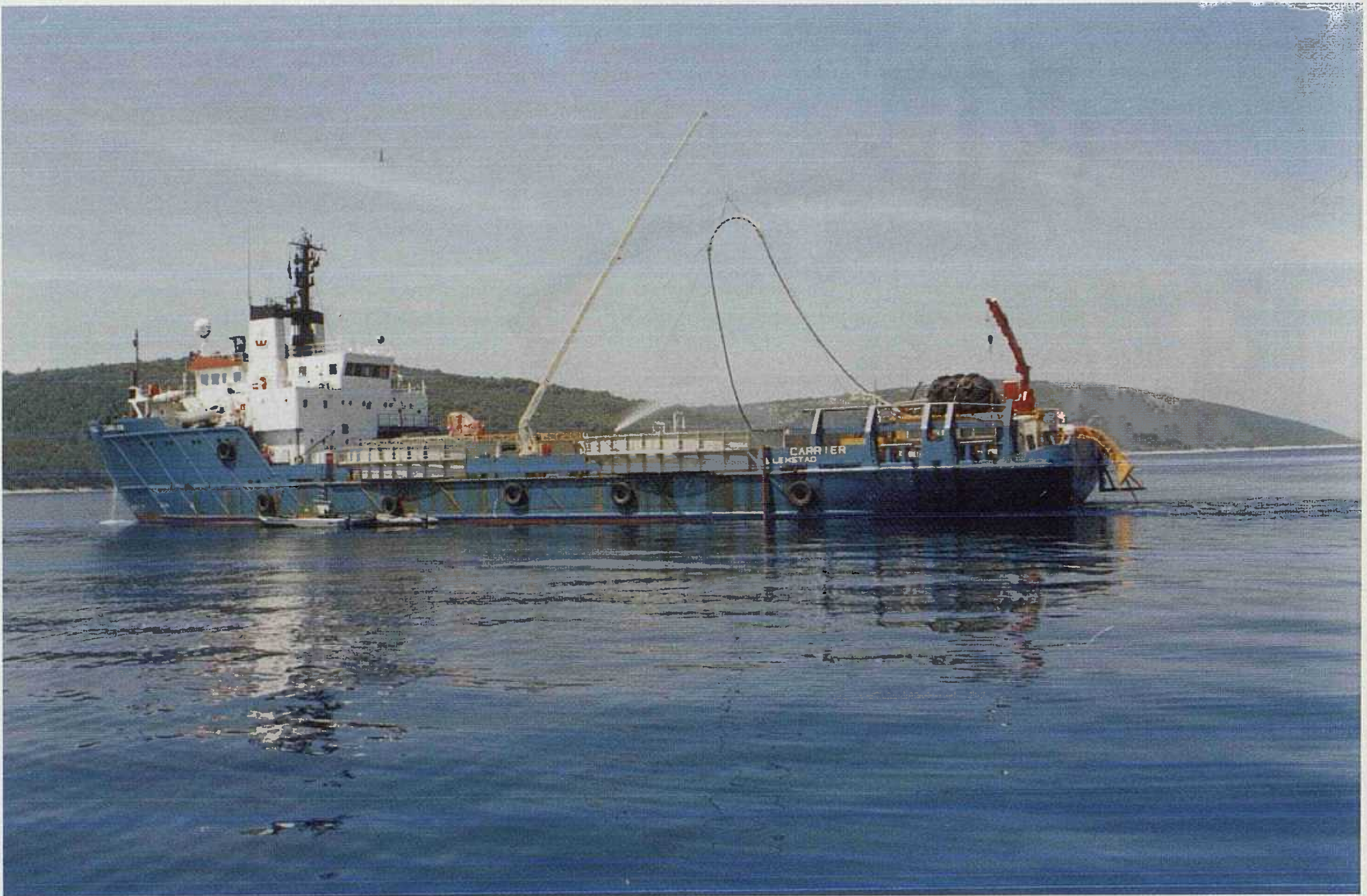
Slika 23. "Cable Carrier" u tijeku polaganja
