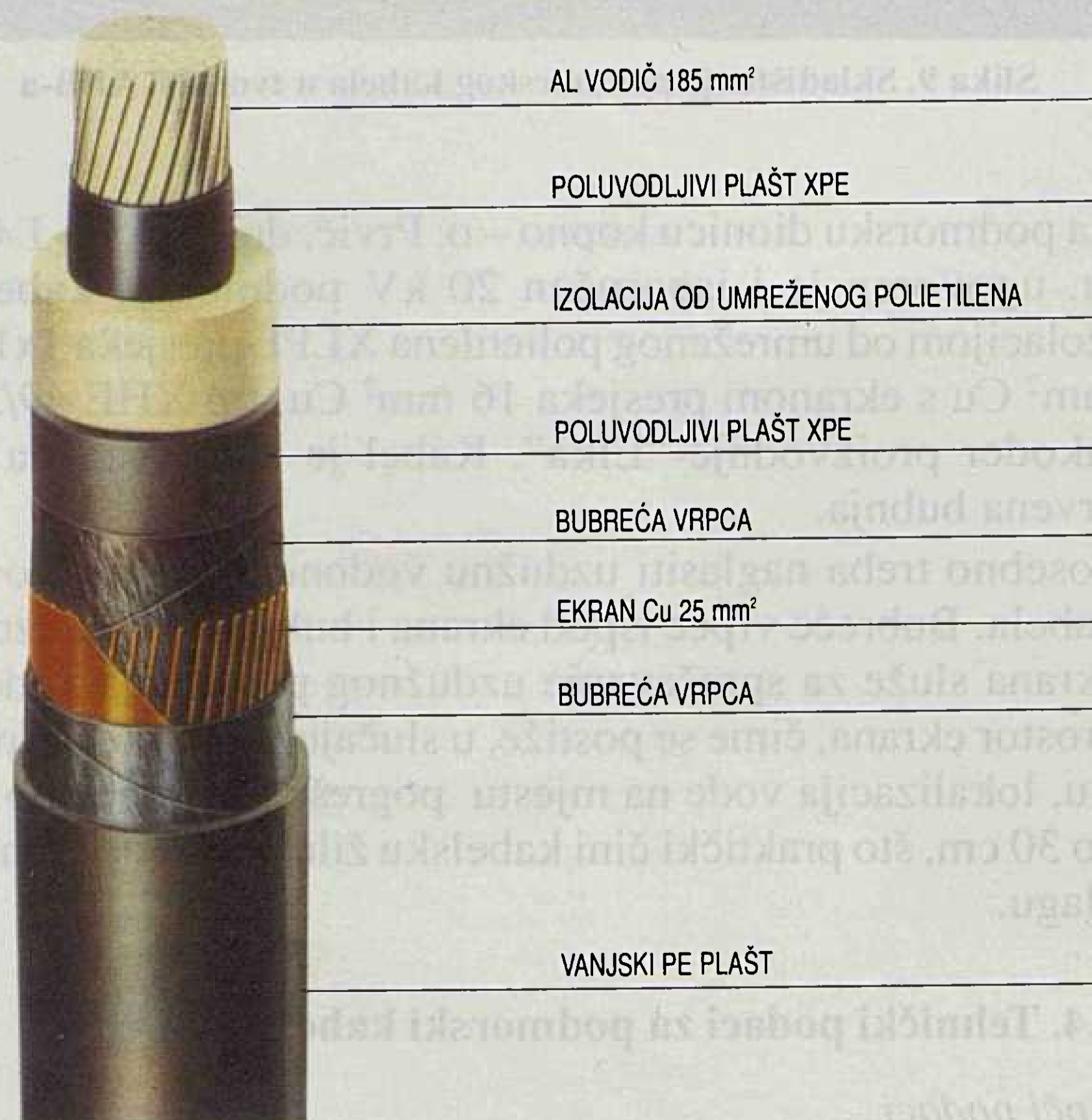
Slika 11. Kopneni kabel tip XHE 49-A proizvodnje “Elka”
