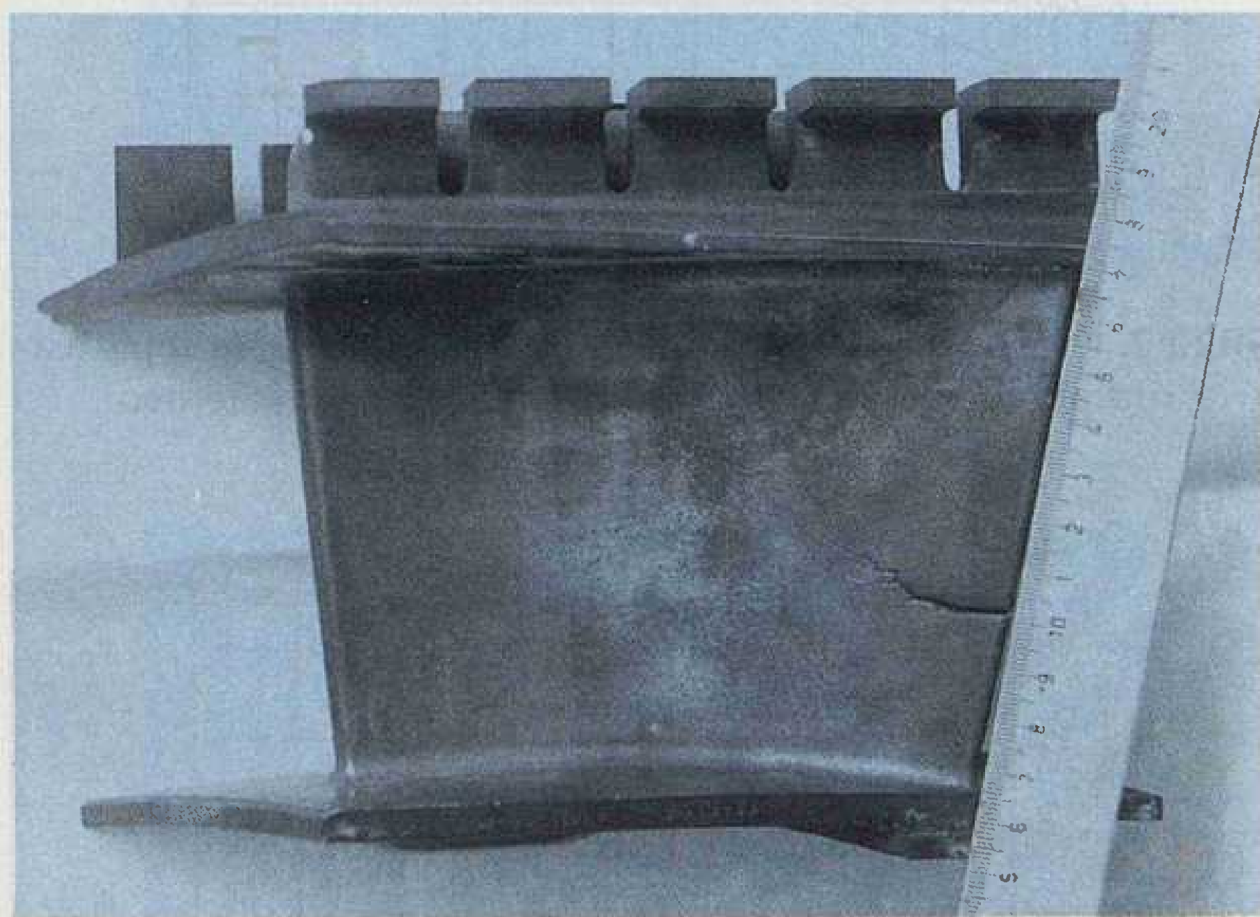
Slika 4. Prikaz pukotine na izlaznom bridu statorske lopaticice prvog stupnja turbine
