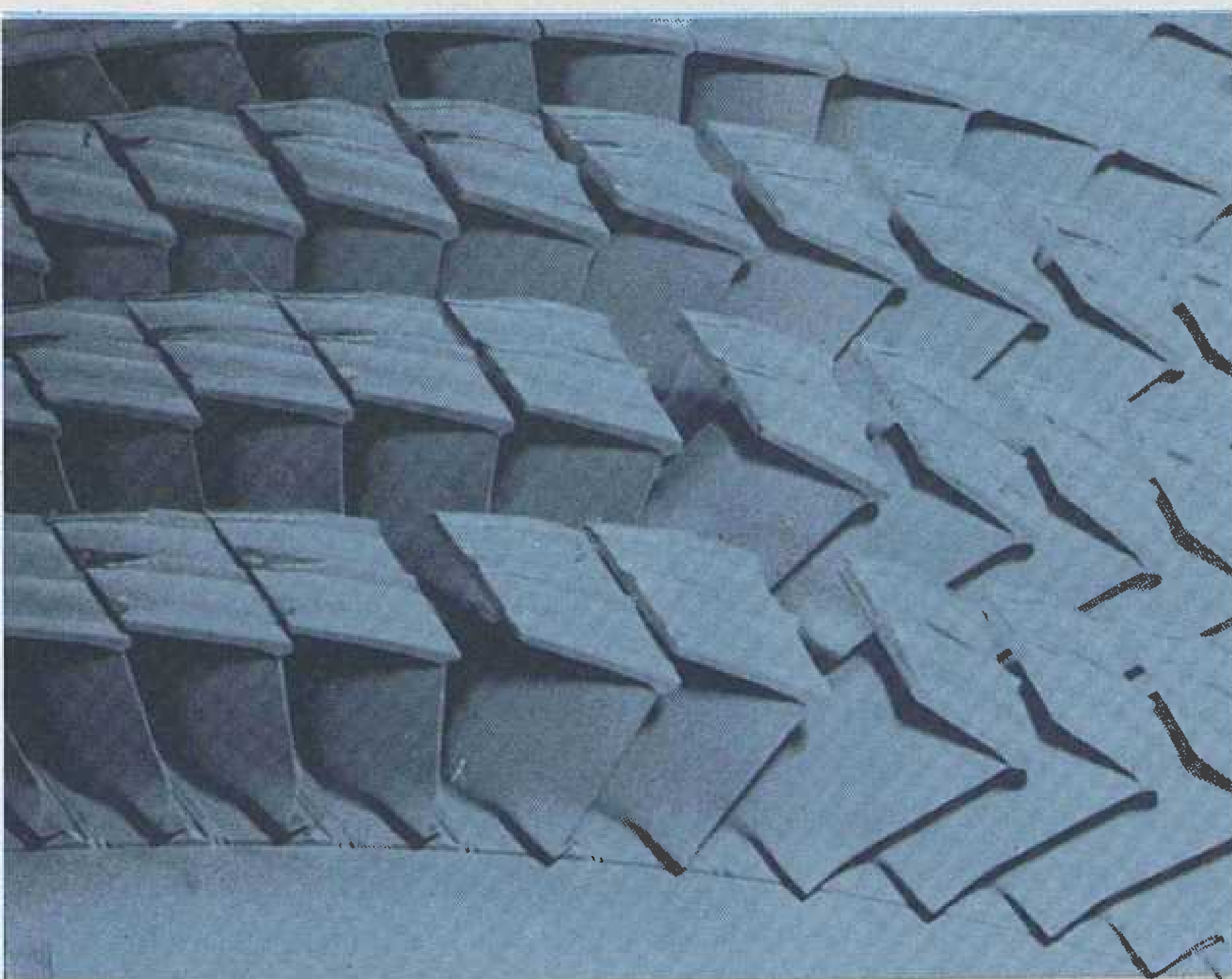
Slika 8. Oštećenje rotorskih lopatica niskog tlaka trokucišne reakcijske kondenzacijske turbine snage 308,5 MW
