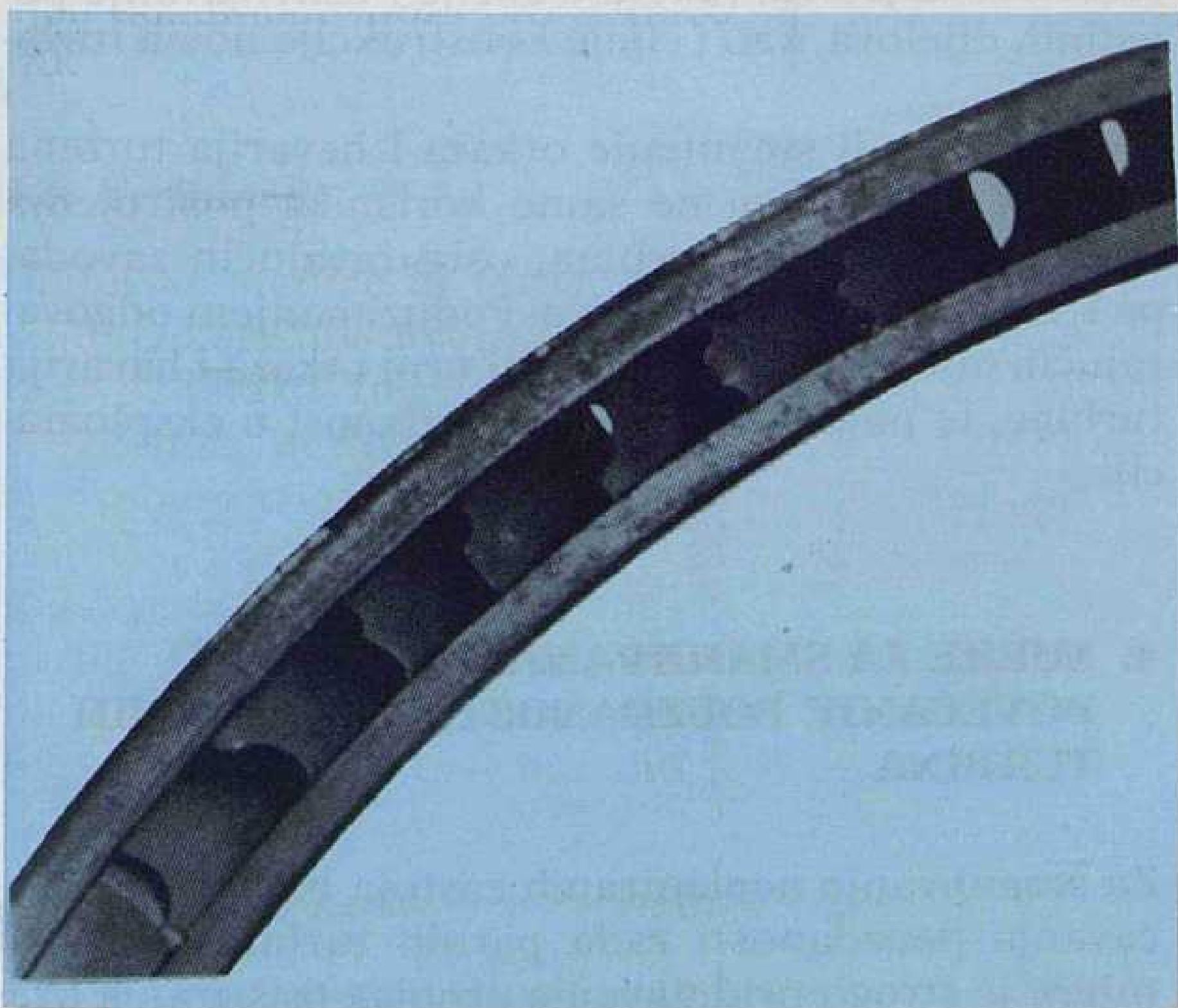
Slika 12. Oštećenje izlaznih bridova sapnica prvog stupnja kondenzacijske turbine s reguliranim oduzimanjem pare, snage 50 MW
