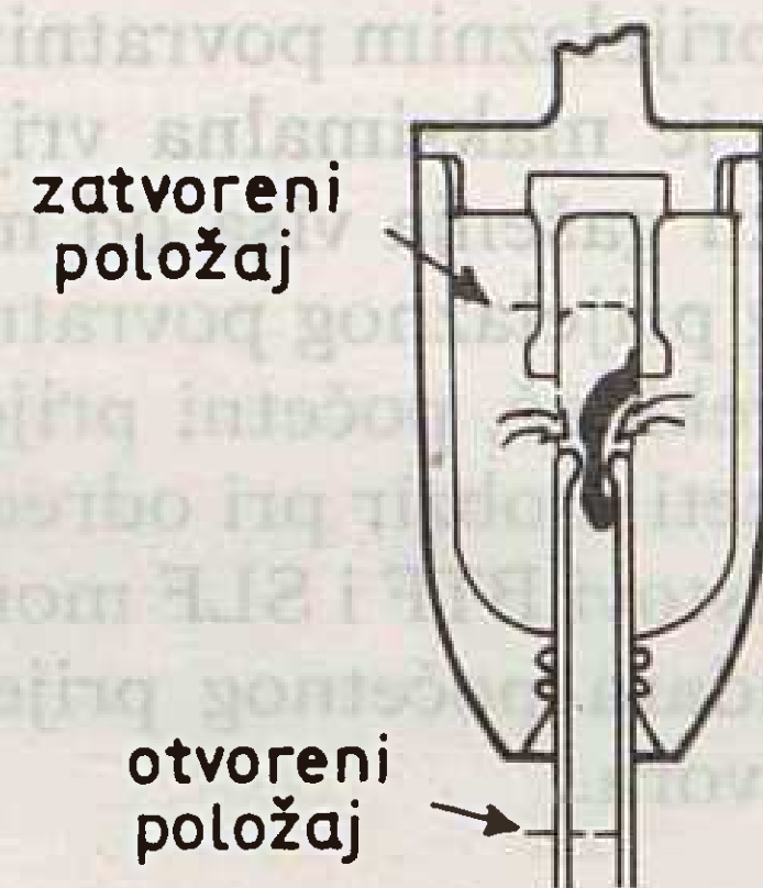
Slika 8. SF 6 prekidna komora s autogašenjem
