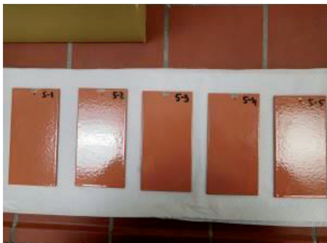
Fig. 7. Test coupons Hempel
