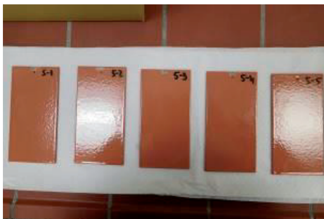
Fig. 8. Test coupons Belzona
