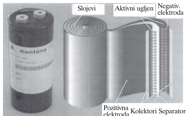
Slika 7. Valjkasta izvedba superkondenzatora [7]
