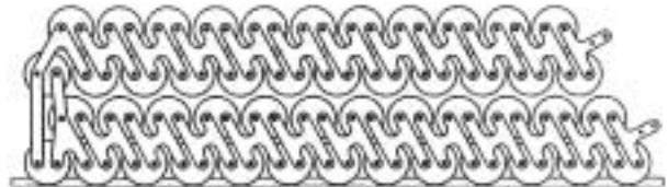
Slika 5. Primjer serijsko-paralelnog spoja više kondenzatorskih ćelija [7]
